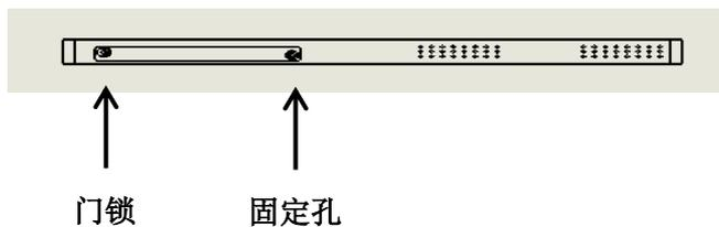
1. 请用钥匙将门锁打开，从班牌底部固定孔中将螺丝拧松，拆下壁挂背板
