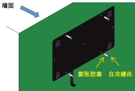
4. 请先将膨胀胶塞嵌入孔内，再使用自攻螺丝将壁挂板与墙面锁紧。
