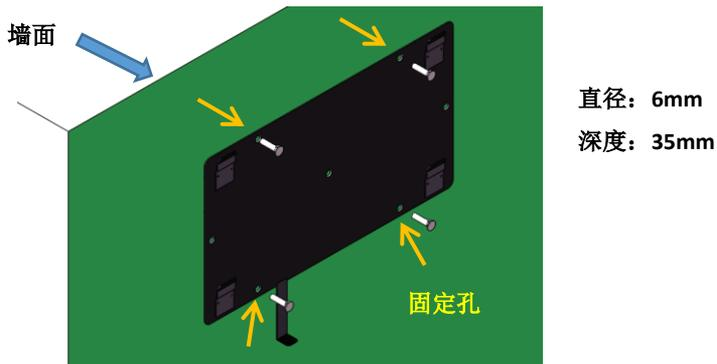
2. 请使用壁挂板和测量工具，在墙上标记需要打孔的位置，安装高度根据实际使用环境及使用人员平均高度而定。
